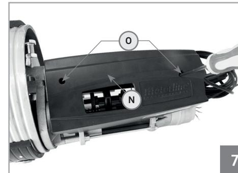
18 • Cerrar el final de carrera a través de la cobertura de plástico (N) y luego apretar con los dos tornillos (O), verificar la correcta disposición de los cables (fig. 7).
