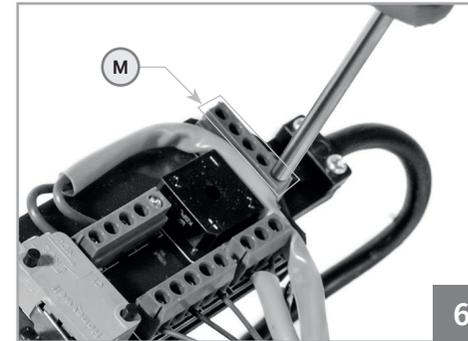
17 • Conectar el terminales (M) del cable de alimentación al final de carrera respetando la dirección correcta (fig. 6). Apriete el terminal a través de los cuatro tornillos.
