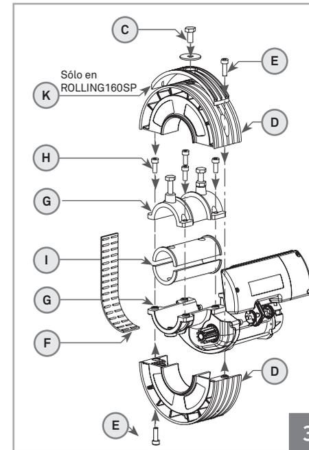
04 • Desmontar la corona (D) desatornillando los dos tornillos M8 (E) como mues la fig. 3.
