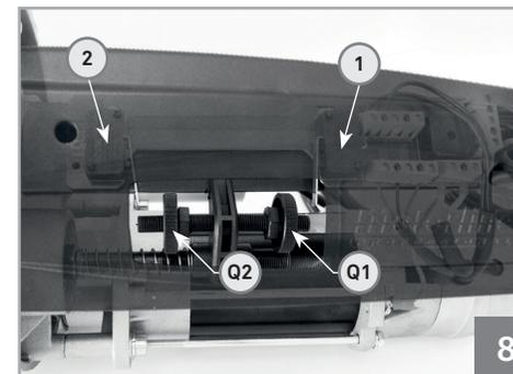
19 • Después de haber efectuado la instalación mecánica y los contactos eléctricos proceder a regular el movimiento final del cierre como mues la fig. 8.
