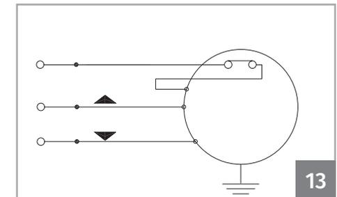
**04** • Conectar el cable del micro interruptor (W) en sucesión al cable de alimentación (común) del motor reductor.
