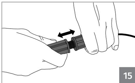
Para desbloquear el motor basta aflojar la pieza de bloqueo que se encuentra en el final del cable de acero, girando para la izquierda. Para volver a bloquear el motor, apriete esa misma pieza.
