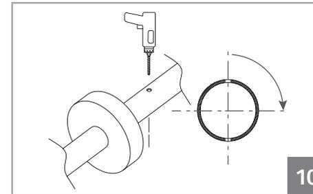
**01** • Efectuar sobre el árbol del cierre metálico una perforación que pasa  $\varnothing 10$  para pedicular al eje.
