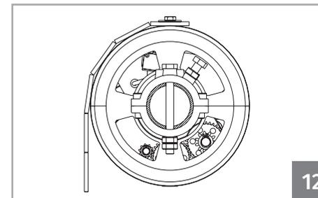
**03** • El lado de bajada de la persiana que coincidir con el lado de bajada del paracaídas. Colocar el motor reductor como se muestra en la figura.
